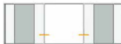
Leichtes Verschieben der Elemente durch integrierte Mitnehmer Easy displacement of the elements by integrated followers
