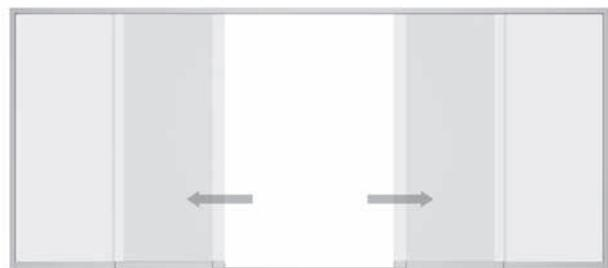
D Leichtes Verschieben der Elemente durch integrierte Mitnehmer
